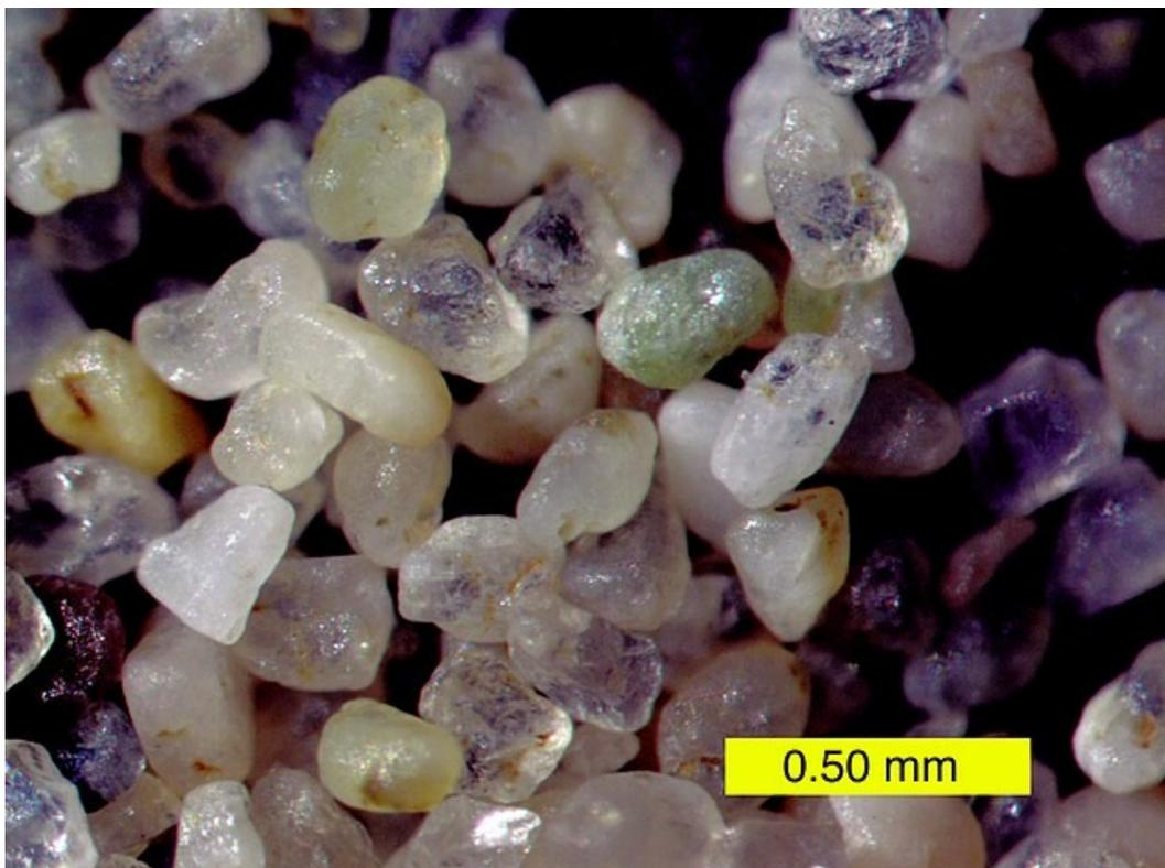
Sable vu au microscope. (« Mark A. Wilson », licence BY SA). Le limon, bien que plus petit, est aussi sous forme de grains.
